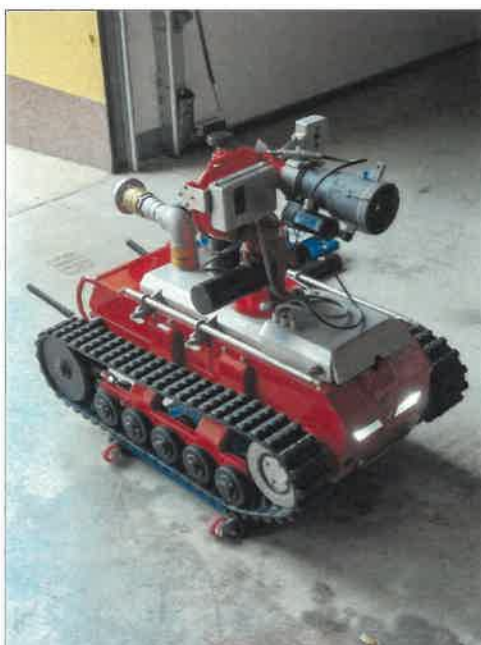
Obrázek č. 1 - Pohled na Robota MRAZ3 s osazeným hasičským modulem.
