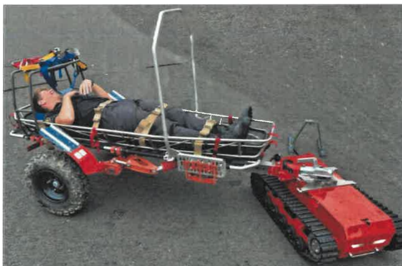
Obrázek č. 4 - Pohled na robota s připojeným dvoukolovým přívěsem s nosítky.
