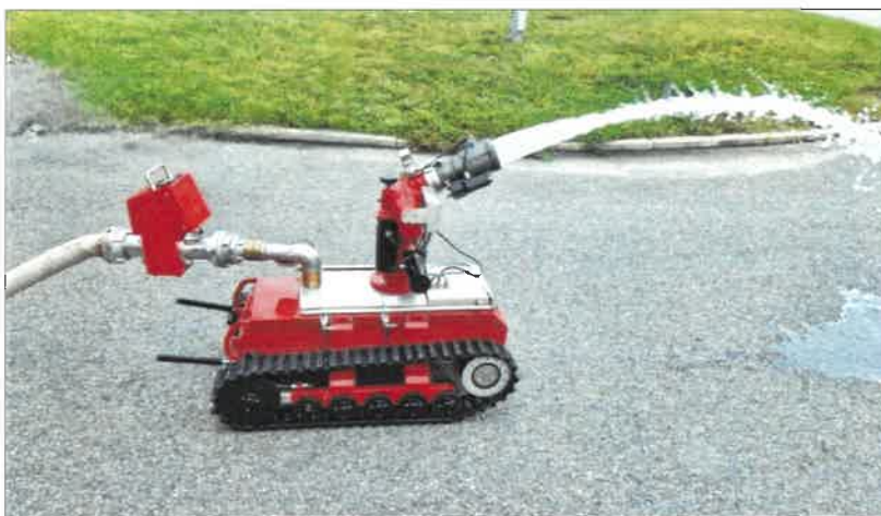
Obrázek č. 3 - Pohled na robota s osazeným hasičským modulem a průtokoměrem.
