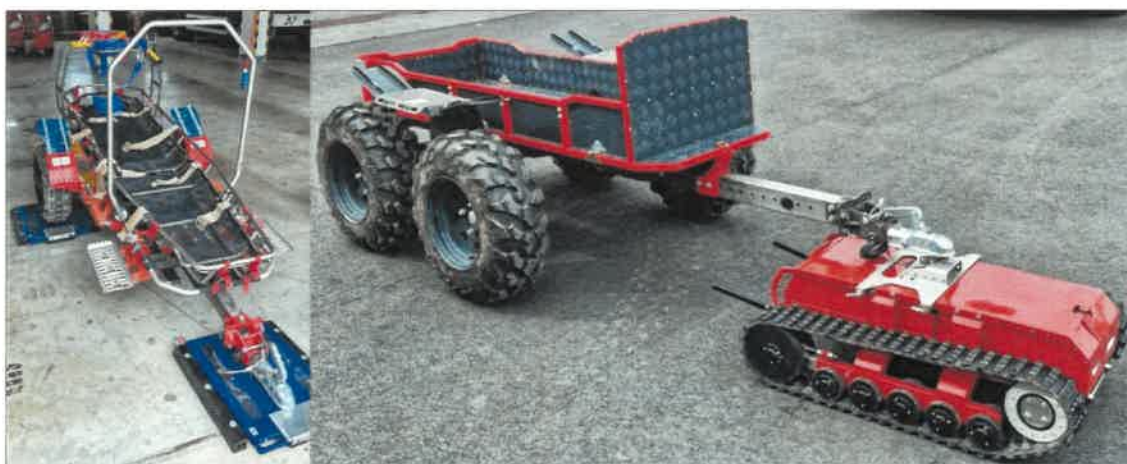
Obrázek č. 2 - Pohled na dvoukolový přívěs s nosítky (vlevo) a čtyřkolový přívěs (vpravo).
